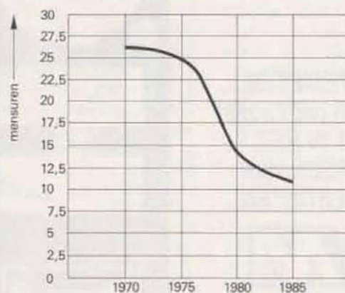
ONTWIKKELING AANTAL MENSUREN NIEUWBOUW/GIETBOUW [4]
